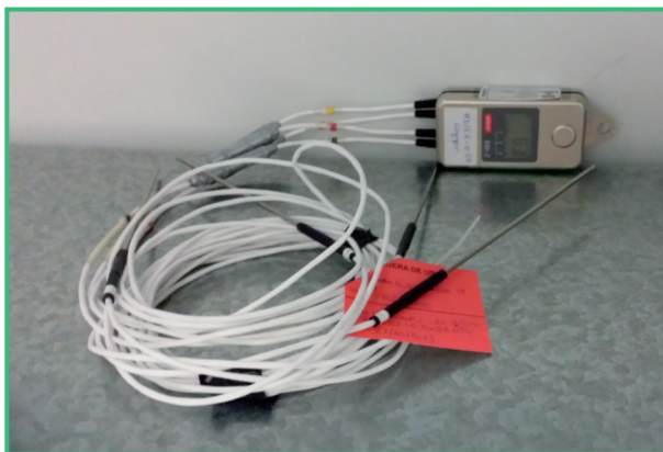
Figura 6. Los equipos de medida deben calibrarse periódicamente guardando registro de este proceso.
